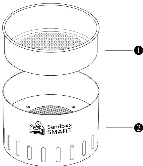
1. Depósito para los granos: pantalla de malla de acero inoxidable con orificios de 5 mm
